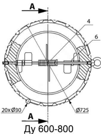
При монтаже в горизонтальном положении, ось клапана должна быть в вертикальном положении.
